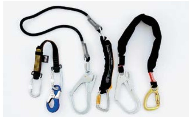
10 Aufreissband, als Falldämpfer in ein Halteseil eingebaut. Bei einer Belastung von etwa 3 kN (300 kg) beginnt das Band aufzureissen.
