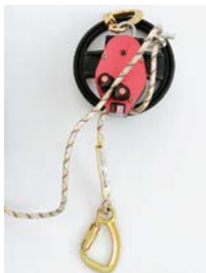
21 Mit einem vorkonfektionierten Rettungssystem (Rettungssack) am Arbeitsplatz kann eine allfällige Rettung einfach sichergestellt werden.
