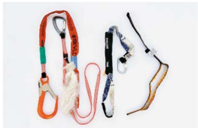
11 Beispiele aufgerissener Falldämpfer. Das Aufreissen dämpft den Fallstoss.
